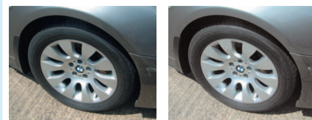
De bandenspanning op de rechter afbeelding is 50% te laag. Ziet u het?
